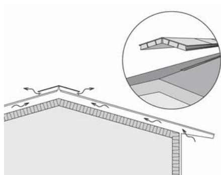
Перед монтажом кровли необходимо убедиться в исправности и достаточной вентиляции основания. Если работы ведутся на кровле с уклоном 1:1 – 1:5, можно усилить вентиляцию кровли с помощью коньковых вентилях Kerabit. Коньковые вентиля устанавливаются по всему коньку. См. специальную инструкцию по монтажу коньковых вентилях Kerabit. До монтажа кровли крепятся трехгранные рейки в основаниях труб и подъемов.
