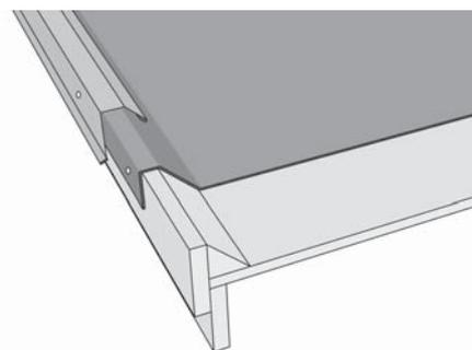
Для **торцевого свеса** имеется три варианта: карнизная планка Kerabit Rästaspelti, торцевая карнизная планка Olallinen Päätyräystäspelti и торцевая карнизная планка Päätyräystäspelti. Две первые следует монтировать до монтажа кровли аналогично окрытиям нижнего свеса. Монтаж окрытий торцевого свеса начинается от нижнего свеса и ведется к коньку.
