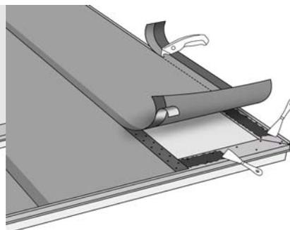
Измерьте крышу и спланируйте полосы на плоскости так, чтобы они размещались на крыше симметрично. При необходимости сузьте крайние ковры.
