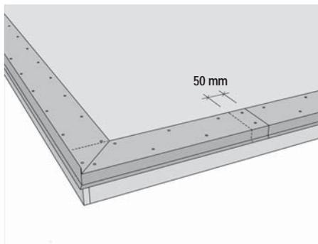
На **нижний свес** монтируется карнизная планка Kerabit. Надставки окрытий монтируются с нахлестом не менее 50 мм и крепятся гвоздями для мягкой кровли или винтами для тонкой плиты с головкой KFR зигзагом с шагом 100 мм. При устройстве надставок капельник верхнего окрытия отгибается, а капельник нижнего окрытия вставляется внутрь отогнутого.
