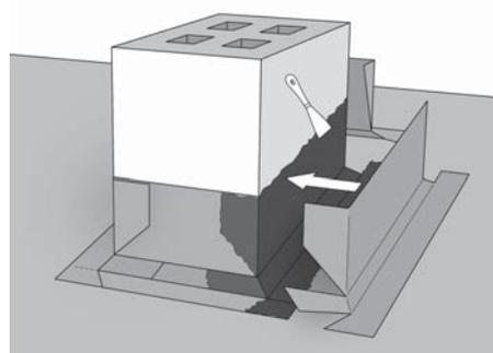
Перед монтажом кровли установите трехгранную рейку в основание трубы или другого большого прохода для уменьшения угла. Уложите Kerabit 3D с нижней стороны сквозного прохода и по сторонам на верхний край трехгранной рейки. Укладываете верхний ковер сквозного прохода лишь тогда, когда полностью смонтировали подъемы на трубу.
