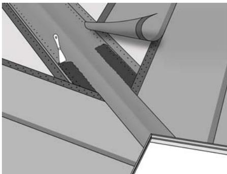
Удалите защитную пленку клеевой полосы нижней поверхности второго ковра и прижмите края с клеевыми полосами друг к другу (накрывается место прибивания зигзагом первого ковра). Окончательно обработайте крепление верхнего края, прибив гвоздями в месте шва. Продолжайте монтаж аналогичным образом до тех пор, пока плоскость не будет готова. Ковер следует приклеивать к покрытию противоположного свеса плоскости битумным клеем.
