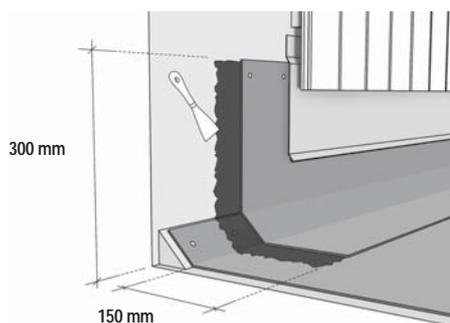
Обрежьте необходимые для устройства подъема края ковра, которые выступают не менее чем на 300 мм на вертикальную поверхность и не менее чем на 150 мм поверх кровли. Приклейте клеевые полосы сплошь и дополнительно зафиксируйте крепление подъема механически, прибив его гвоздями. Защитите подъем жестяным погонажем, чтобы вода не попала между ковром и вертикальной поверхностью.
