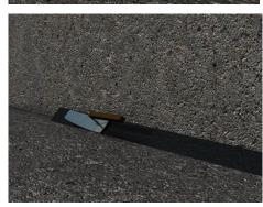
Адгезию плинтуса к основанию проверяют с помощью шпателя и прикаточного ролика.
